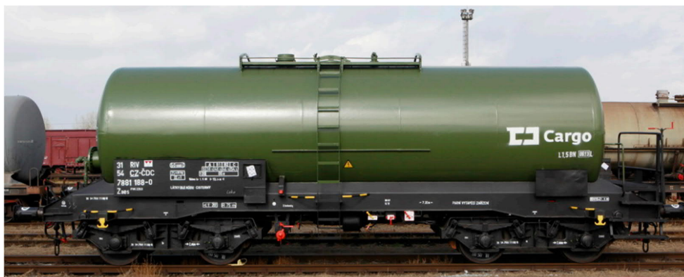
Obrázek 14 – Železniční cisterna ZAES 30 [39]
