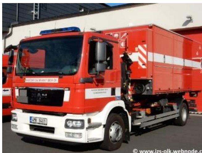
Obrázek 33 – ANK M s hydraulickou rukou, MAN TGM, stanice Šumperk [37]
