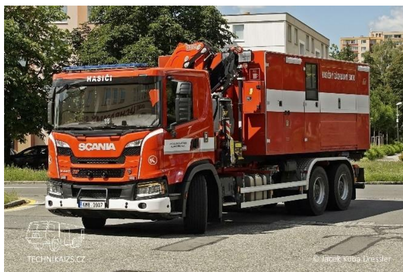
Obrázek 46 – KNP na ANK S, Scania, stanice Šumperk [46]
