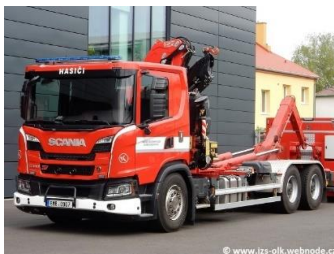
Obrázek 28 – ANK S s hydraulickou rukou, Scania, stanice Přerov [37]
