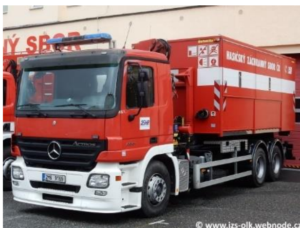
Obrázek 31 - ANK S s hydraulickou rukou, MB Actros, stanice Olomouc [37]
