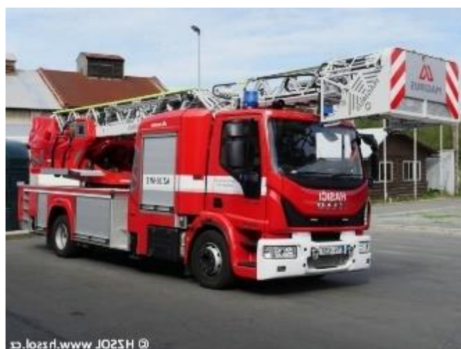
Obrázek 14 – AZ 30 s košem, Iveco, stanice Šumperk [29]
