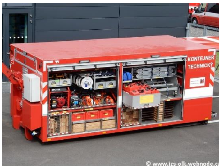
Obrázek 38 – KTE destrukce, stanice Přerov [30]
