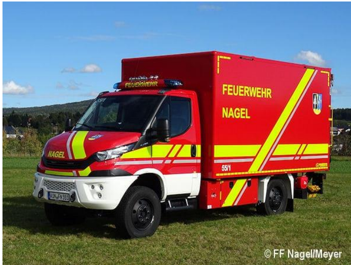
Obrázek 56 – Gerätewagen GW 1 německých hasičů, vzor pro NA s hydraulickým čelem [59]
