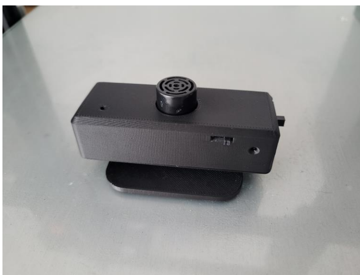
Obrázek 8.2: Pohled na přepínač signalizace detektoru překážek
