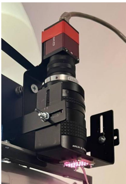
Obrázek 4.4: Fotorefrakční předsádka haploskopu v duálním akomodometru
