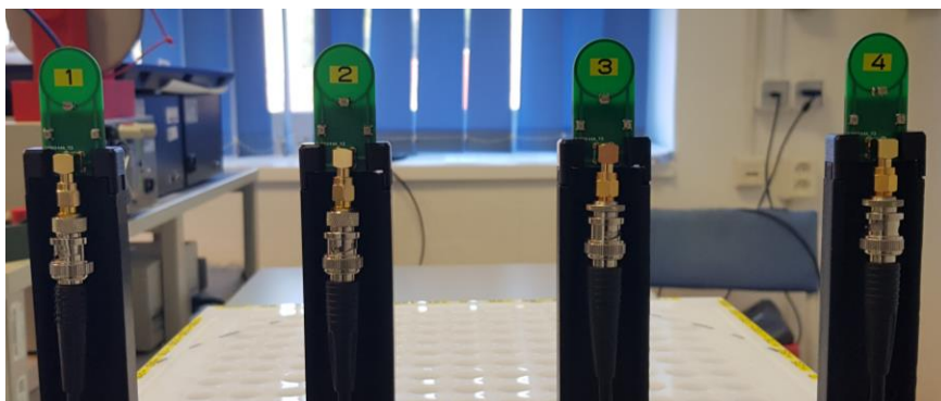
Obrázek 28: Přijímací antény s pevnými kondenzátory a stíněním na zadní straně tištěného spoje, pro zamezení příjmu indukce signálu ve spodní části obvodu, kde je umístěn ladící obvod antény [36]
