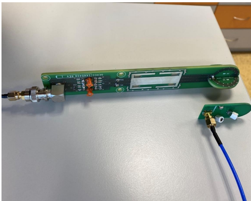
Obrázek 38: Fotografie simulátoru jaderného spinu s přijímací anténou z měření S_{21} parametru
