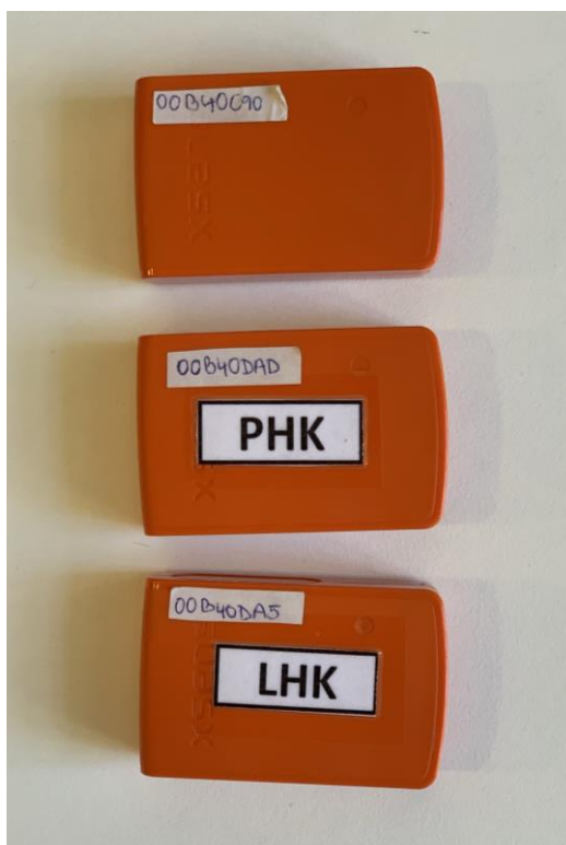
Obrázek 4.1 Označené akcelerometry. Fotografie: autor
