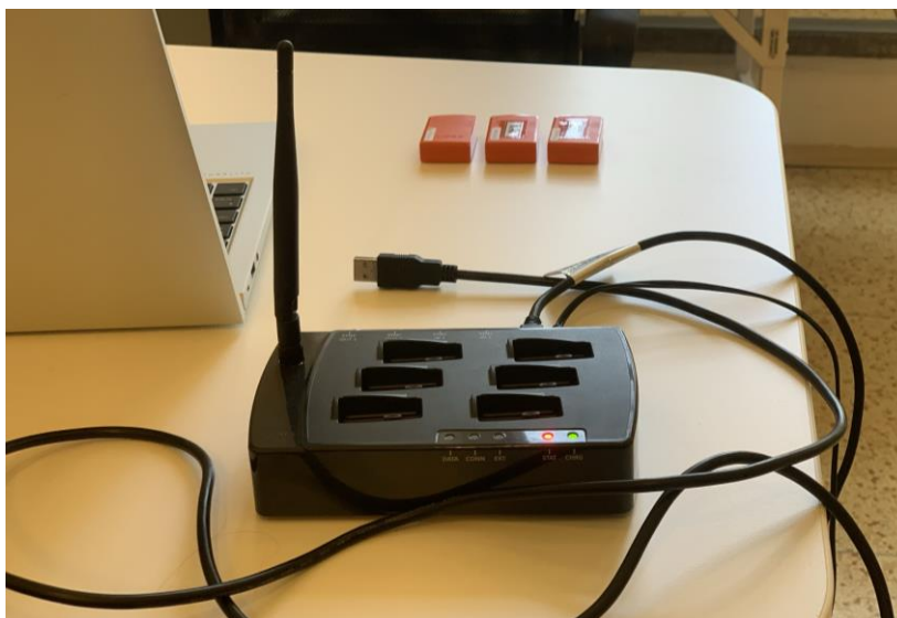
Obrázek 4.2 Dokovací stanice pro akcelerometry. Fotografie: autor
