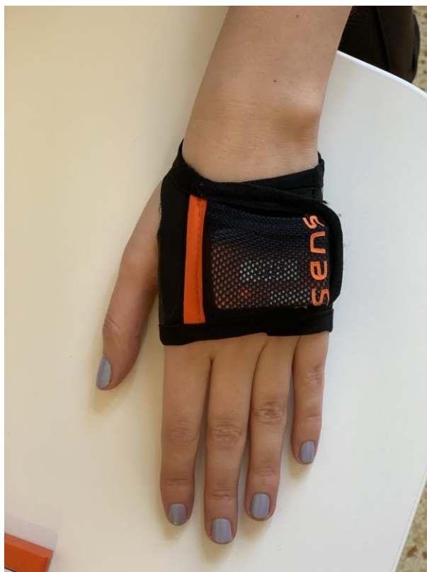
Obrázek 4.4 Rukavice s akcelerometrem. Fotografie: autor
