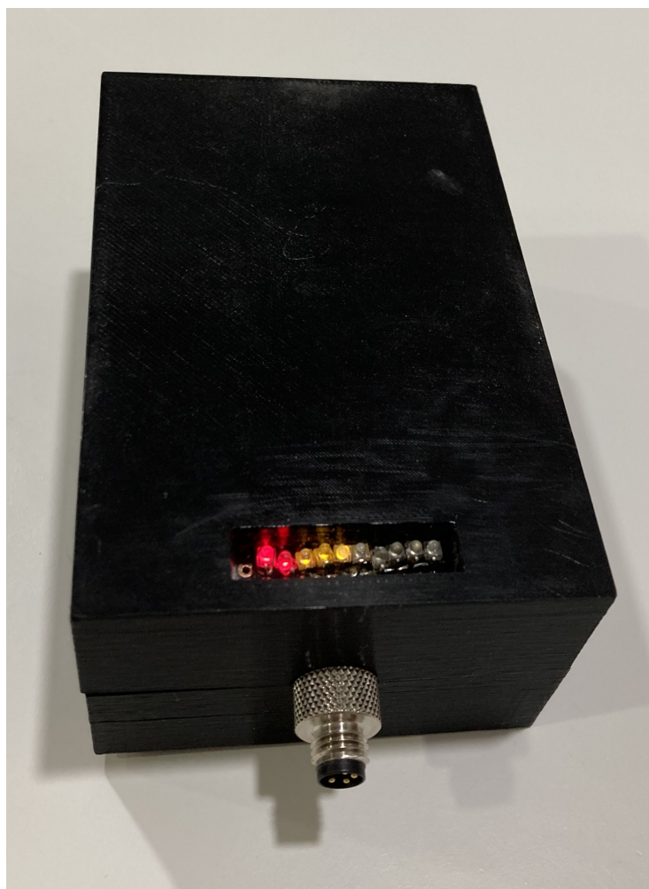
Obrázek 7.2: Fotka sestaveného zařízení pro měření EEG biopotenciálu s pomocí desky Cyton od firmy OpenBCI.
