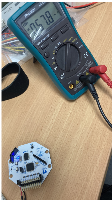
Obrázek 7.1: Fotka měření odběru proudu, při dvoukanálovém zapojení.
