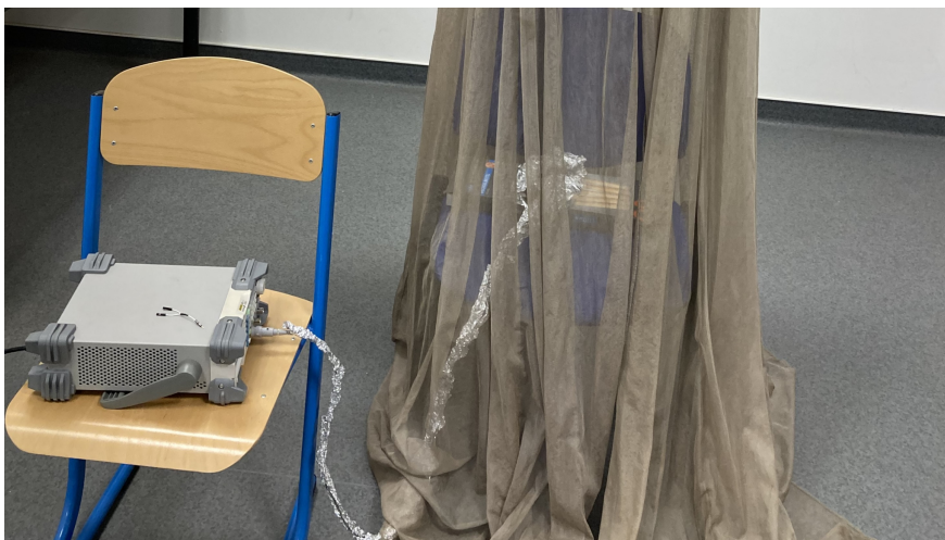
Obrázek 4.3: Měření ve Faradayově kleci (realizované pomocí sítě s hustě protkanými drátky) se stíněnými kabely.
