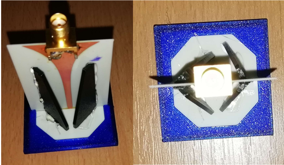
Obrázek 4.6.13: Podoba antény s přidanými podporami
