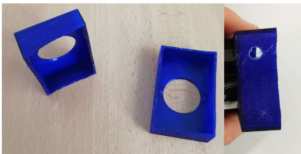
Obrázek 4.6.9: Vytištěné části formy pro sestavení antény
