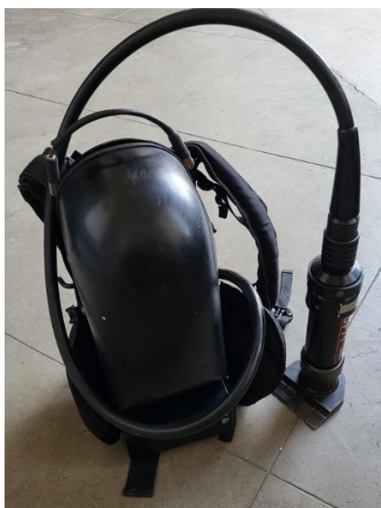
Obrázek 13 Systém hydraulického otevírání dveří [autor]
