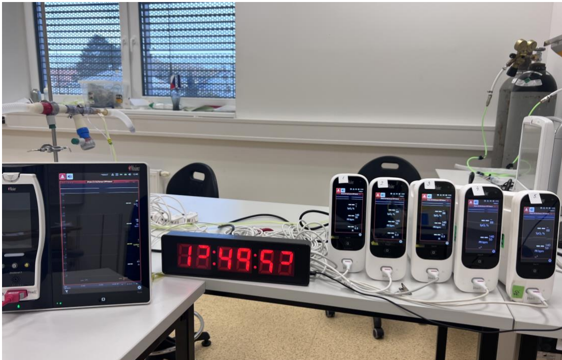
Obr. 4. 4: Vzhled pracoviště včetně přístrojového vybavení – pulzní oxymetry Masimo Rad-97, dýchací okruh, patientský monitor Carescape B650, tlaková lahev (dusík).
