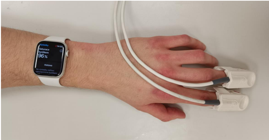
Obr. 4.1: Nasazené hodinky Apple Watch 8, referenční oxymetr Radical-7 (prostředník), kontrolní oxymetr Root (ukazovák).
