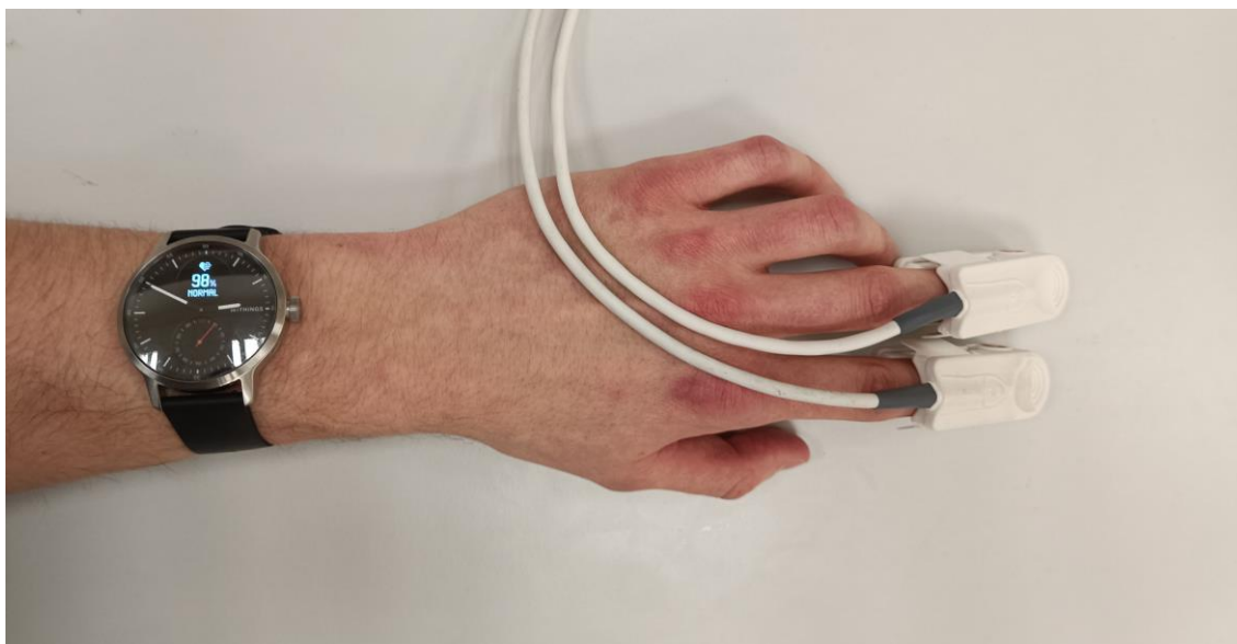
Obr. 4.3: Nasazené hodinky Withings ScanWatch, referenční oxymetr Radical-7 (prostředník), kontrolní oxymetr Root (ukazovák).
