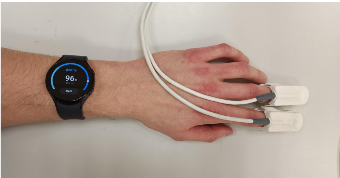
Obr. 4.2: Nasazené hodinky Samsung Galaxy Watch 5, referenční oxymetr Radical-7 (prostředník), kontrolní oxymetr Root (ukazovák).
