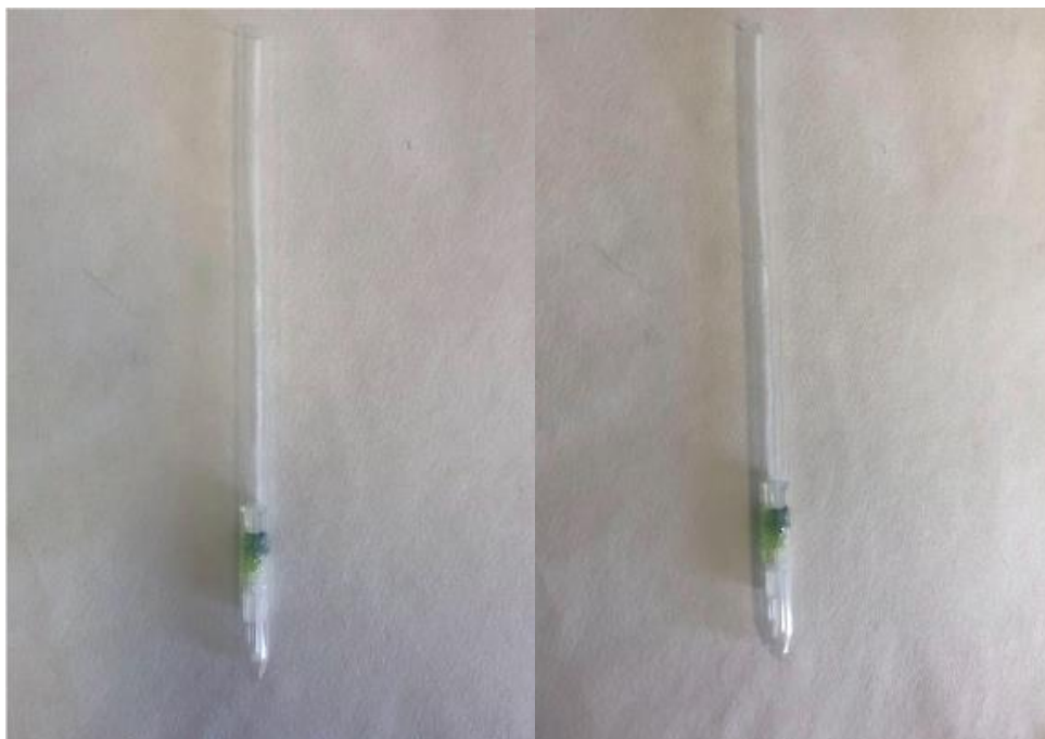
Obrázek č. 17 vlevo – Zbarvení detekční trubičky pokusu č. 6 po 1 minutě, zdroj: vlastní
