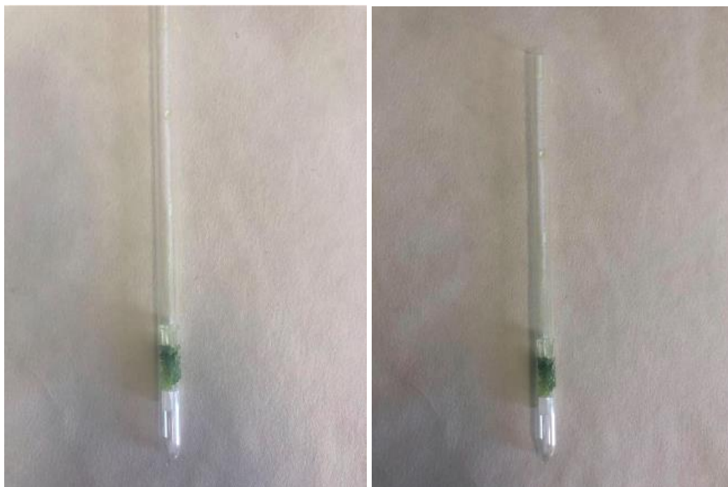
Obrázek č. 15 vlevo – Zbarvení detekční trubičky pokusu č. 5 po 1 minutě, zdroj: vlastní
