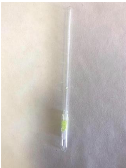
Obrázek č. 11 vlevo – Zbarvení detekční trubičky pokusu bez aplikace alkálie po 1 minutě, zdroj: vlastní
