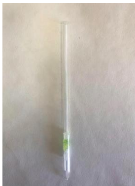
Obrázek č. 13 vlevo – Zbarvení detekční trubičky pokusu č. 4 po 1 minutě, zdroj: vlastní
