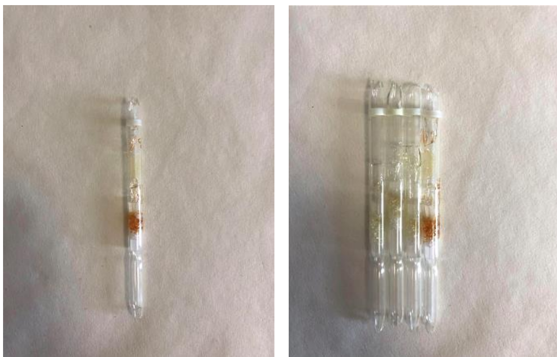
Obrázek č. 50 vlevo – Trubička po vystavení nasyceným párám toluenu a po rozbití ampule s činidlem, zdroj: vlastní
