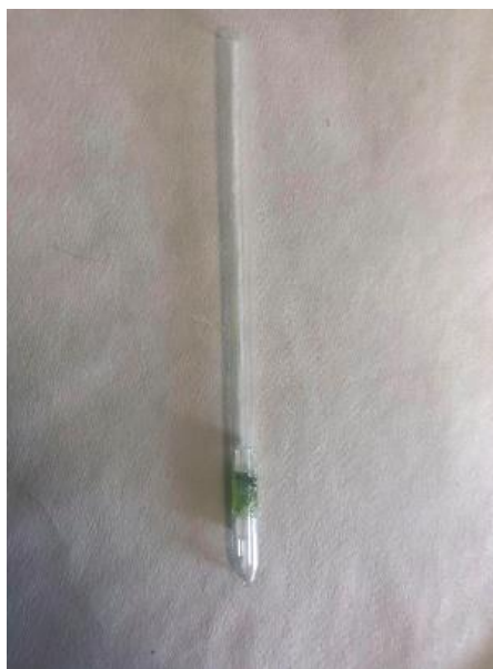
Obrázek č. 21 vlevo – Zbarvení detekční trubičky pokusu č. 8 po 1 minutě, zdroj: vlastní
