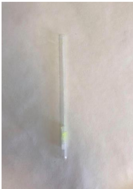
Obrázek č. 7 vlevo – Zbarvení detekční trubičky slepého pokusu po 1 minutě, zdroj: vlastní
