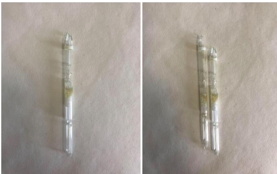
Obrázek č. 46 vlevo – Trubička po aplikaci látky CR a po rozbití ampule s činidlem, zdroj: vlastní
