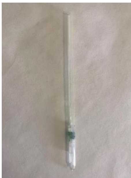
Obrázek č. 25 vlevo – Zbarvení detekční trubičky pokusu č. 10 po 1 minutě, zdroj: vlastní
