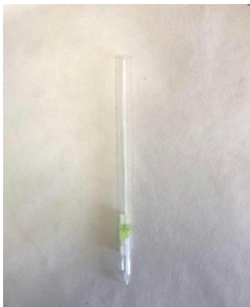
Obrázek č. 13 vlevo – Zbarvení detekční trubičky pokusu č. 4 po 1 minutě, zdroj: vlastní
