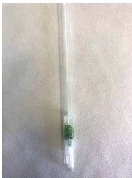
Obrázek č. 9 vlevo – Zbarvení detekční trubičky pokusu č. 2 po 1 minutě, zdroj: vlastní
