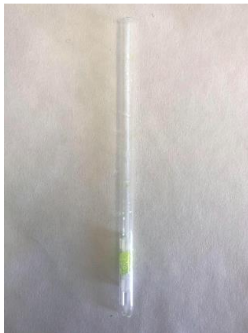
Obrázek č. 11 vlevo – Zbarvení detekční trubičky pokusu bez aplikace alkálie po 1 minutě, zdroj: vlastní
