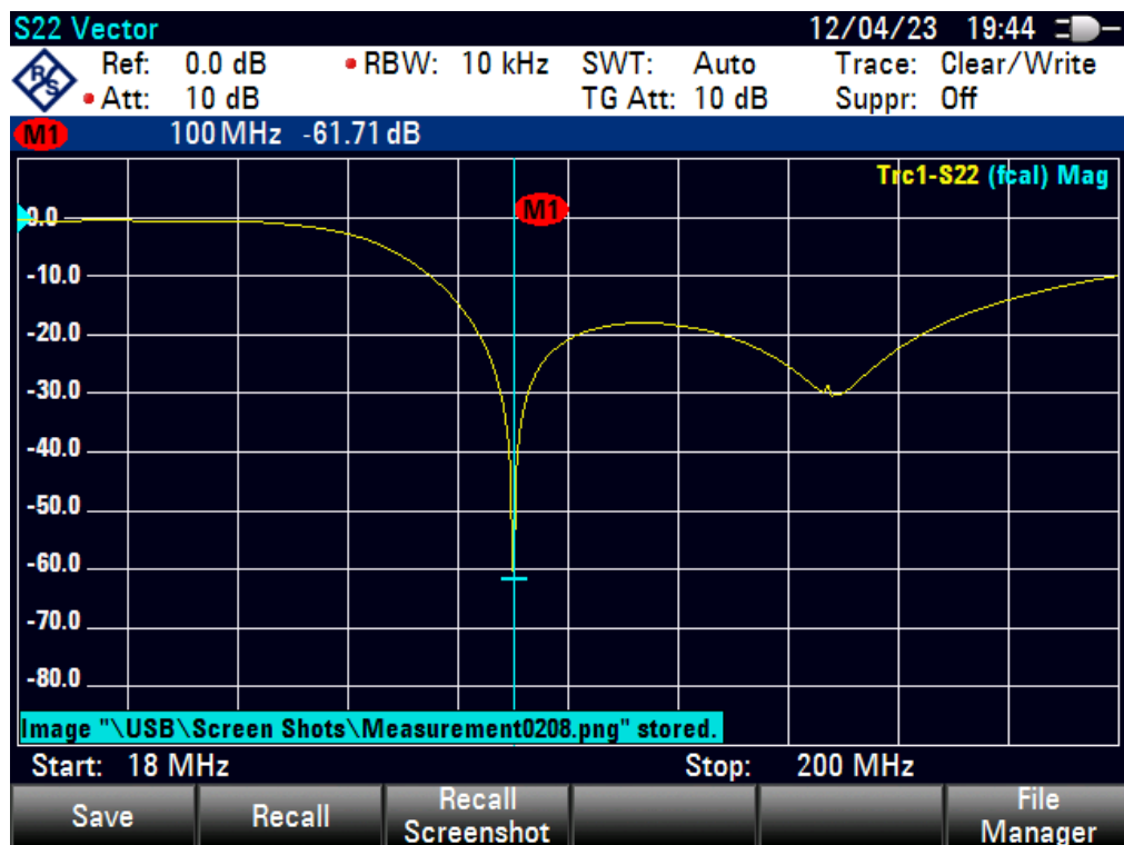
Obr. 4.30: Parametr S22 simulátoru spinu dosahoval útlum až -61,7 dB na frekvenci 100 MHz [zdroj: autor]
