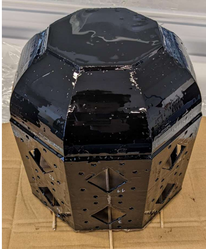
Obrázek 7.15. Ukázka prototypu při procesu potírání epoxidem.
