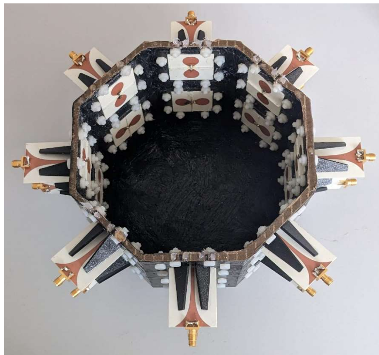
Obrázek 7.18. Laboratorní prototyp UWB mikrovlnného systému.
