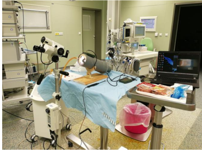
Obr. 4.14: Testování návrhu konečné verze simulátoru na operačním sále B v ÚPMD. Při tomto testování bylo mimo jiné experimentálně zjišťováno vhodné nastavení výkonu elektrochirurgické jednotky.
