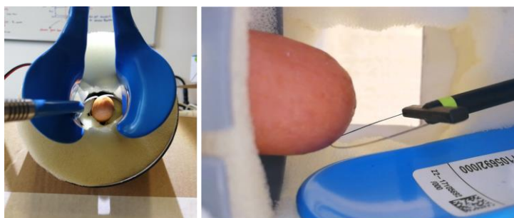
Obr. 4.3: Pohled do první verze simulátoru. Vlevo pohled zepředu skrz gynekologická zrcadla, vpravo pohled shora. Na pravé fotografii je vidět umístění zelené značky na elektrochirurgické kličce.
