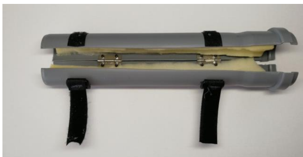
Obr 4.2: Malá otevírací odpadní trubka, která byla použita v prvních dvou verzích simulátoru.
