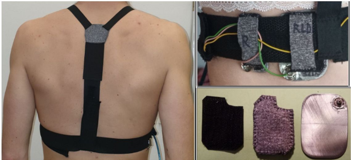
Obrázek 4.9 Fixace nerezových elektrod k tělu.
