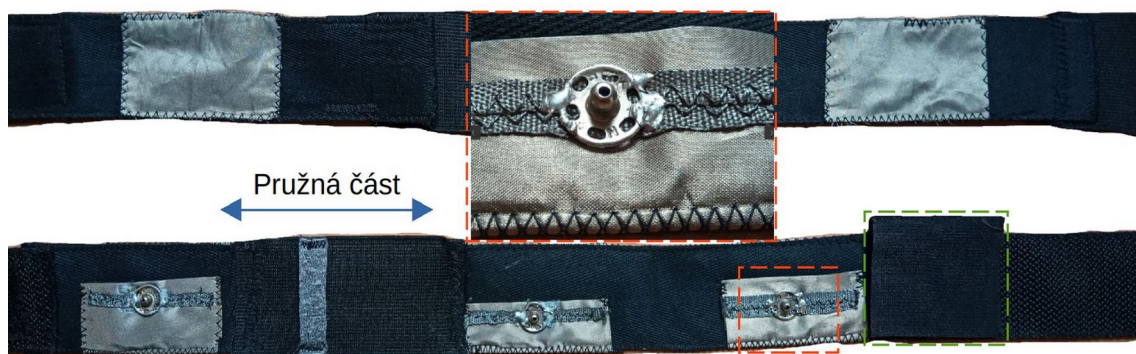
Obrázek 4.10 Hrudní pásy s elektrodami z vodivé tkaniny, zeleně označena kapsa na zařízení.
