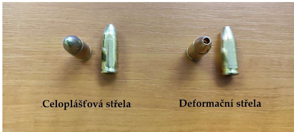
Obrázek 3 – Rozdíl Celoplášťové a deformační střely [vlastní zpracování]
