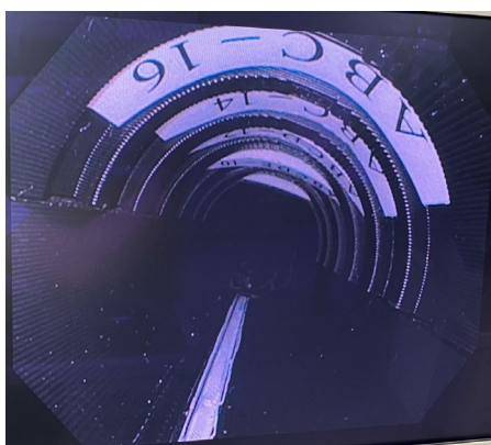
Obrázek 45: Písmena a čísla pro odzkoušení rozlišovací schopnosti endoskopu
