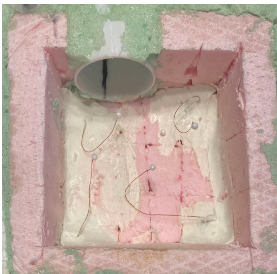
Obrázek 9: Měděné dráty s polypy uvnitř dutiny, pohled shora
