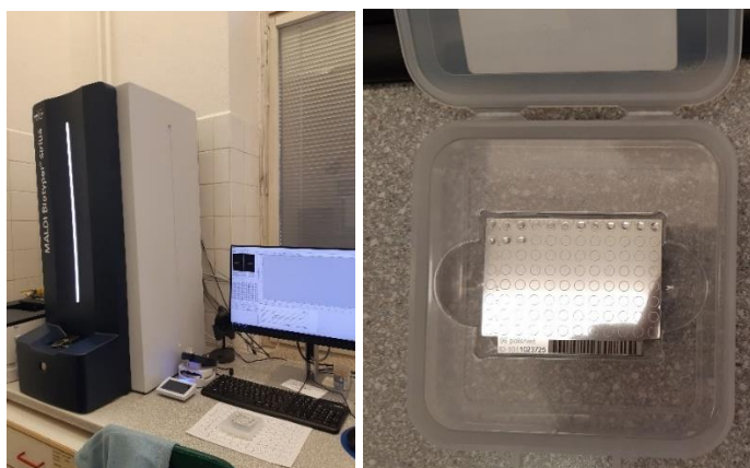
Obrázok 7- Prístroj MALDI Biotyper® sirius (vľavo); MALDI nosič s aplikovanými vzorkami (vpravo) (Cornelia Čereiová, 2023)
