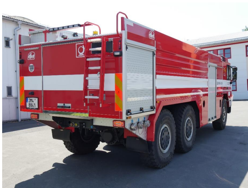
Obrázek 26 Velkokapacitní cisternová automobilová stříkačka na podvozku Tatra 815-7 (zdroj: autor)
