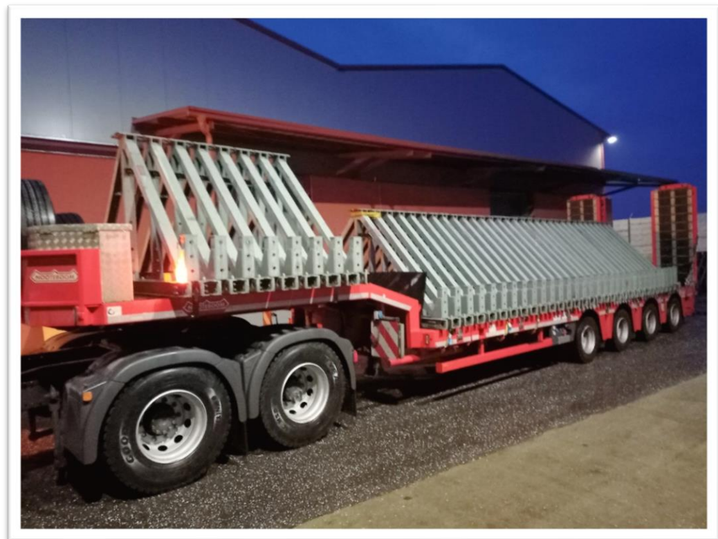
Obrázek 7 Zesílená mostovka dopravována na Ukrajinu ve spolupráci s HZS ČR 1 [29]
