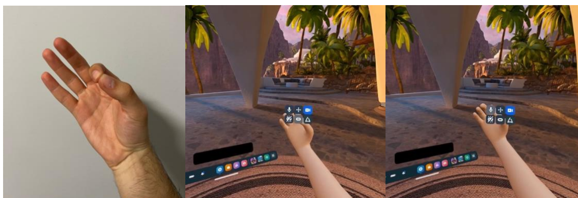
Obrázek 3.7 Ukázka gesta pro otevření tlačítka „Oculus“. Zdroj: vlastní
