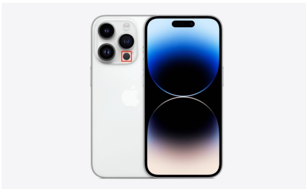
Obrázek 2.9 iPhone 14 Pro (upraveno pro zvýraznění senzoru LiDAR). Zdroj: (18)
