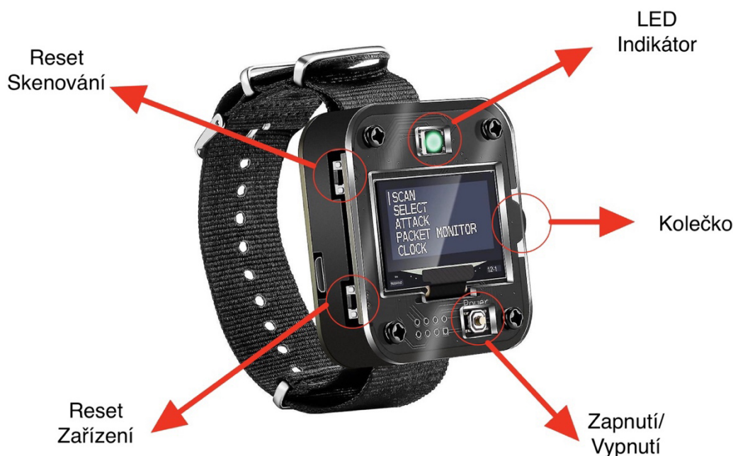
Obrázek 3.1: Schéma s popisem zařízení Deauther Watch V2. Upraveno, Zdroj: (19)
