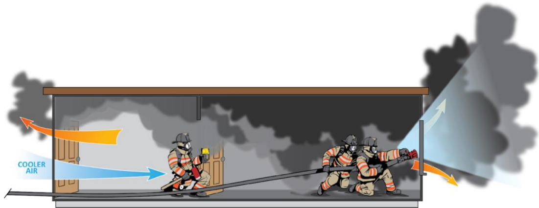
Obrázek 5 Ventilace za použití vodního proudu [22]
