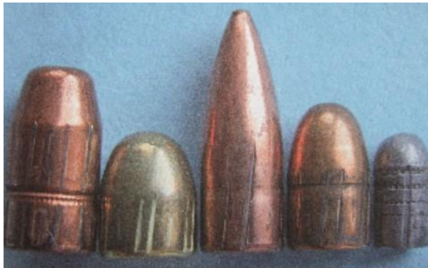
Obrázek 6 Stopy po vystřelení z drážkové hlavni na povrchu strel
