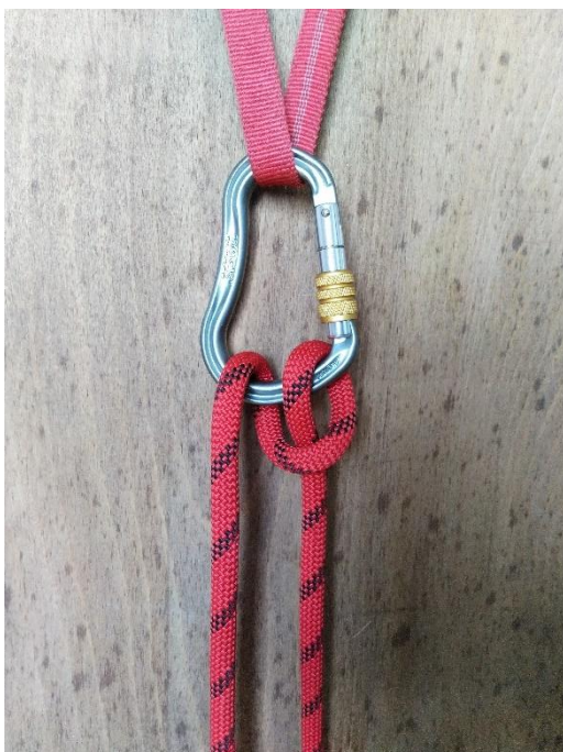
Obrázek 5 – Poloviční lodní smyčka založená v karabině [zdroj vlastní]
