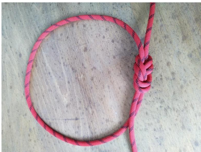
Obrázek 36 – Lanová smyčka vytvořená po směru pícháním dvojitým osmičkovým uzlem [zdroj vlastní]
