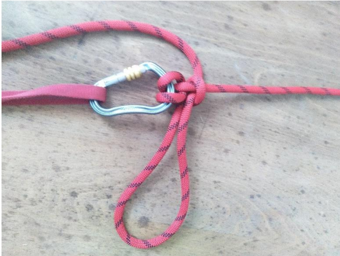
Obrázek 25 – Poloviční lodní smyčka v karabině zajištěná zadržovací smyčkou [zdroj vlastní]
