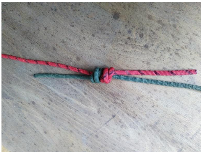
Obrázek 22 – Spojení dvou lan pomocí dvojitých rybářských uzlů [zdroj vlastní]
