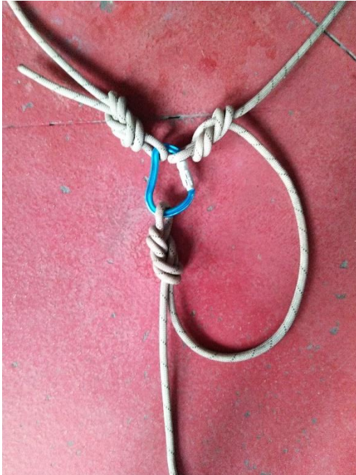
Obrázek 8 – Navázání ke kotevnímu bodu s velkým průměrem pomocí tří osmičkových ok v karabině [zdroj vlastní]
