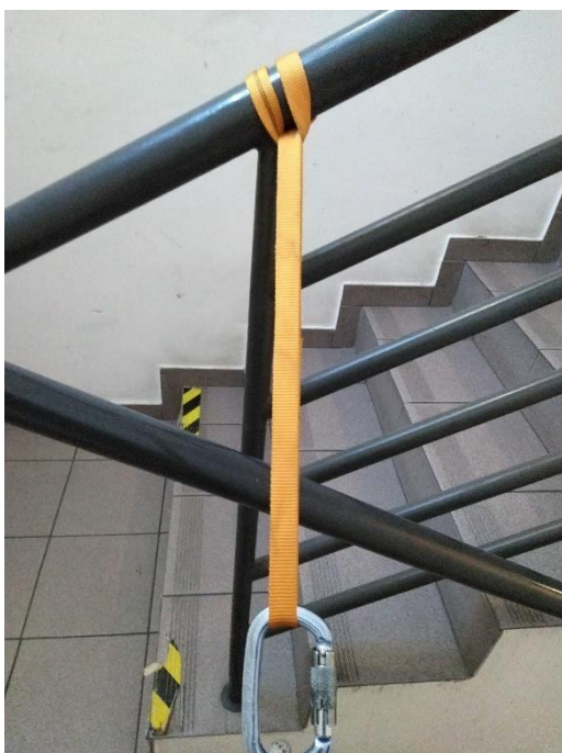
Obrázek 16 – Kotvení pomocí liščí smyčky na šité textilní smyčce a karabiny [zdroj vlastní]
