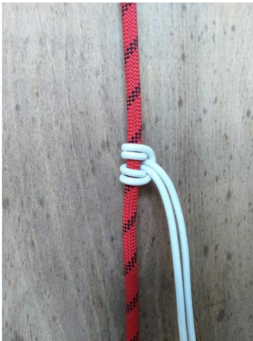
Obrázek 18 – Prusíkova smyčka tvořená pomocnou šňůrou na laně [zdroj vlastní]
