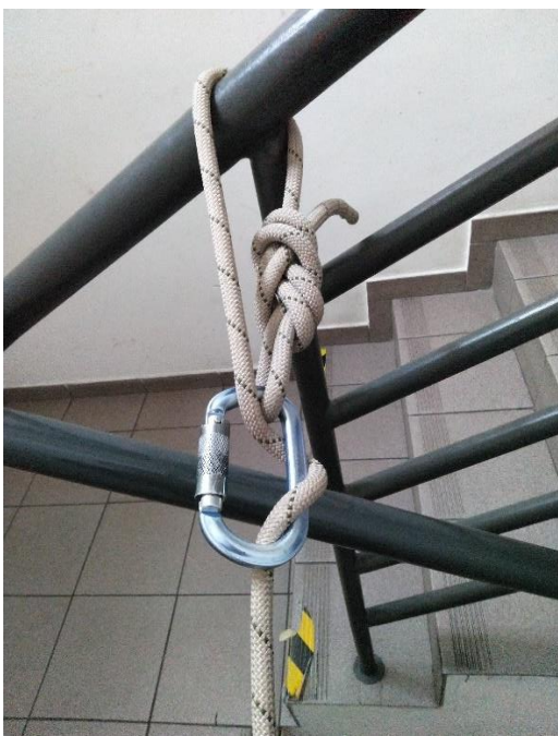
Obrázek 10 – Kotvení pomocí osmičkového oka a karabiny [zdroj vlastní]
