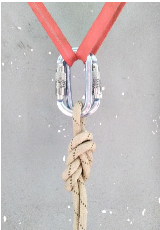
Obrázek 32 – Kotvení lanového přístupu s dvěma karabinami zámky proti sobě [zdroj vlastní]
