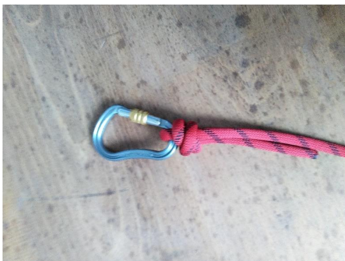
Obrázek 23 – Navázání karabiny do osobní smyčky dvojitým rybářským okem [zdroj vlastní]
