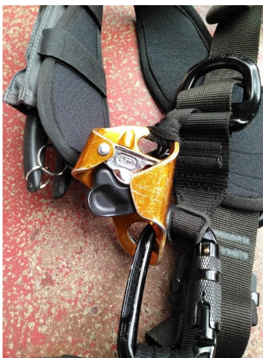
Obrázek 20 – Hrudní blokant na postroji [zdroj vlastní]
