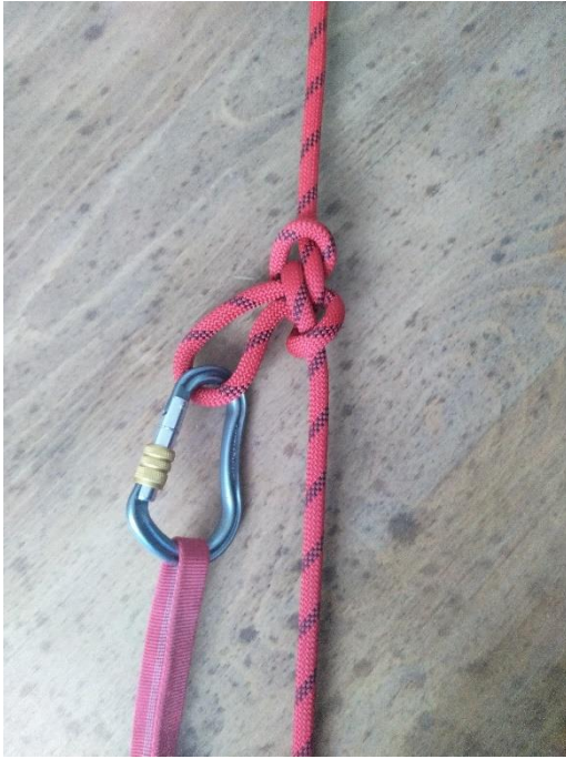
Obrázek 27 – Alpský motýlek zatížený v oku [zdroj vlastní]
