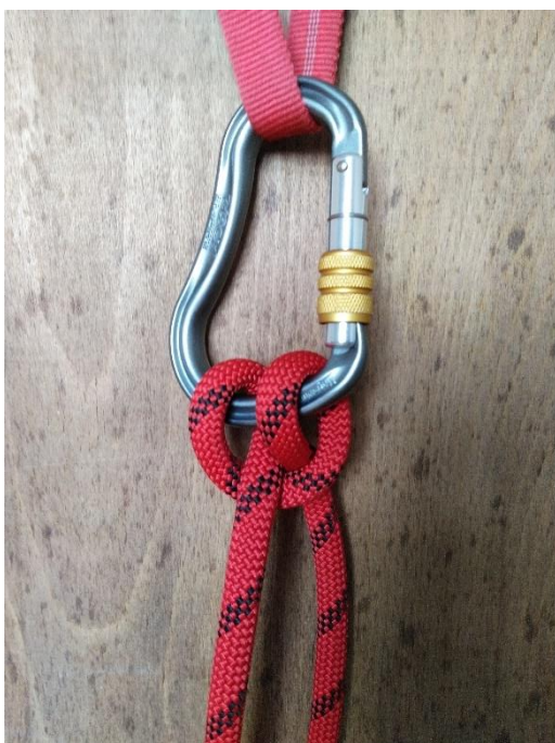
Obrázek 6 – Dvojitá lodní smyčka založená v karabině [zdroj vlastní]
