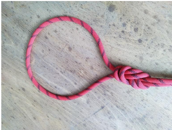
Obrázek 35 – Oko vytvořené protisměrně pícháním dvojitým osmičkovým uzlem [zdroj vlastní]
