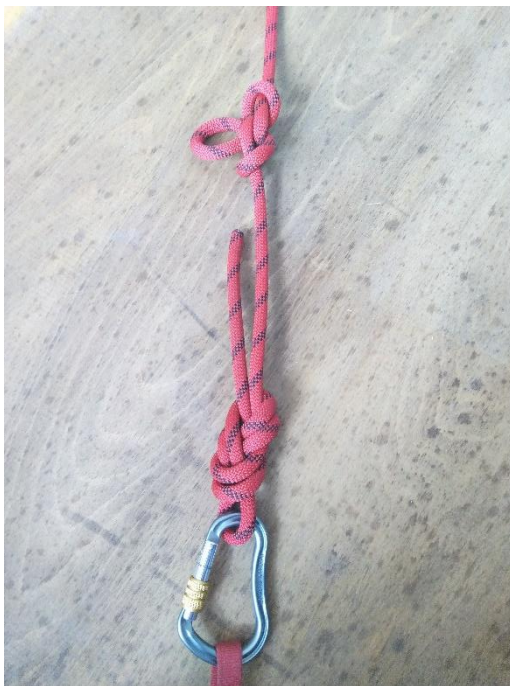
Obrázek 28 – Alpský motýlek zatížený ve směru lana [zdroj vlastní]
