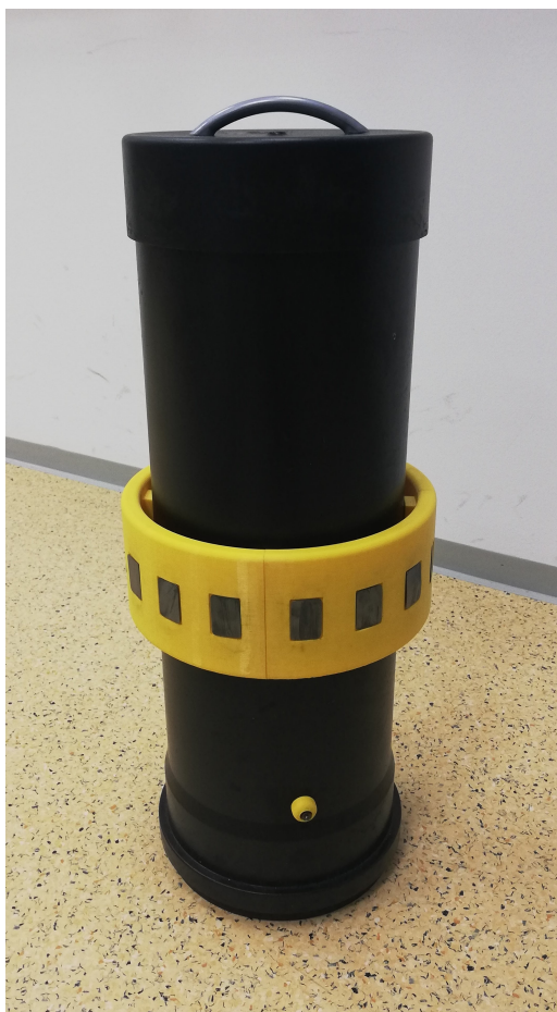
Obrázok 4.6: Fantóm hrudníka pre elektródové pásy veľkostí S a M.
