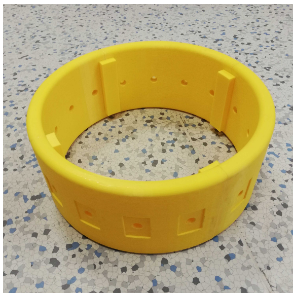
Obrázok 4.4: Rám pre umiestnenie elektródových pásov veľkostí S a M.
