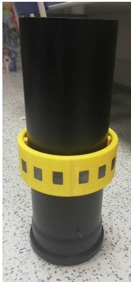
Obrázok 4.5: Rám s elektródami osadený na KG trúbke.
