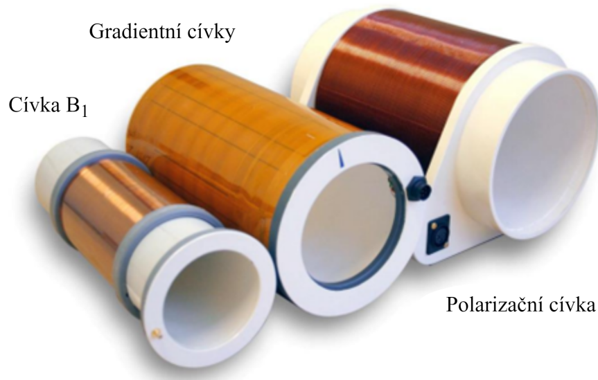
Obrázek 4.2: Rozložená MRI sonda složená ze tří soustředných cívek. Převzato z [8].
