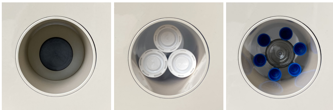
Obrázek 5.12: Vodní fantomy použity pro 2D zobrazování pomocí sekvence Gradient Echo.
