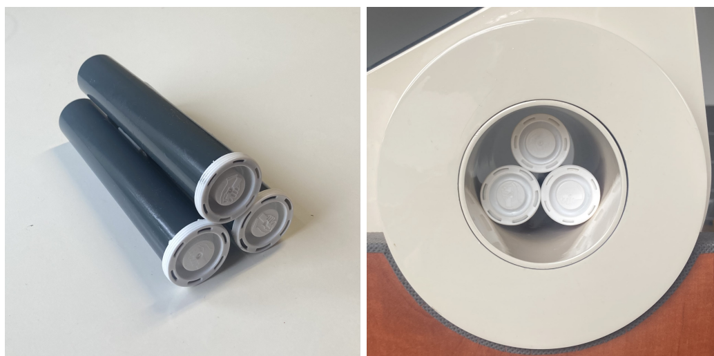
Obrázek 4.10: Vodní fantom vyrobený ze tří tubusů.
