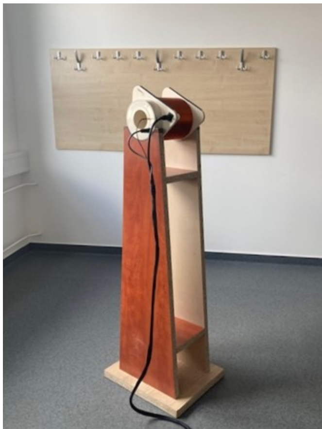
Obrázek 5.1: Umístění sondy v prostoru na speciálním podstavci kolmo na sever.
