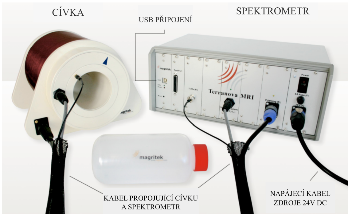
Obrázek 4.3: Kompletní měřicí soustava složená ze sondy, spektrometru, vzorku a kabelů. Převzato z [8].
