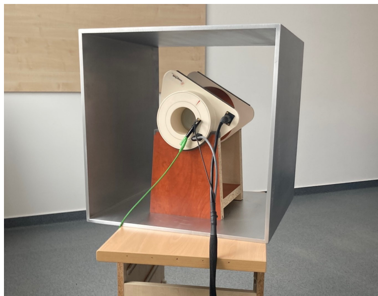
Obrázek 4.11: Snímek z měření se systémem Terranova MRI v hliníkovém stínícím boxu.
