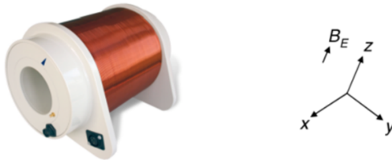
Obrázek 4.1: Měřicí sonda Terranova MRI pro umístění vzorku. Převzato z [8].
