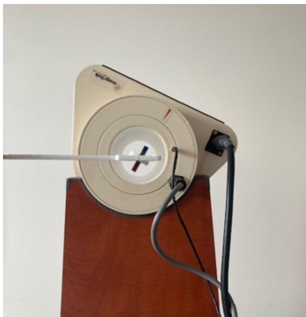
Obrázek 5.2: Natočení sondy ve žlabu pomocí 3D kompasu po směru magnetických siločar.
