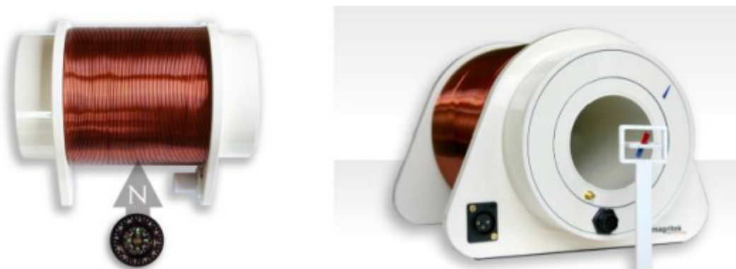
Obrázek 4.4: Demonstrace správného natočení sondy Terranova MRI. Převzato z [29].
