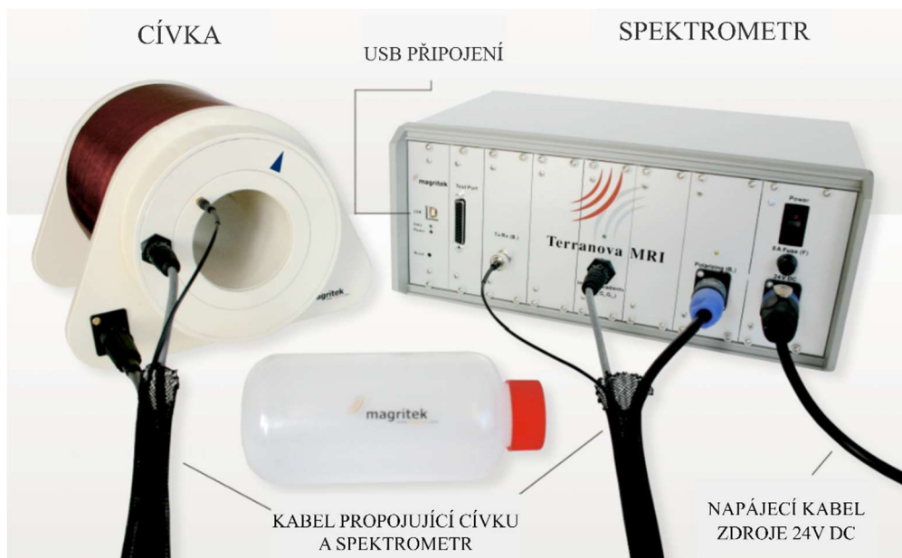
Obrázek 1: Kompletní měřicí soustava složená ze sondy, spektrometru, vzorku a kabelů. [1]
