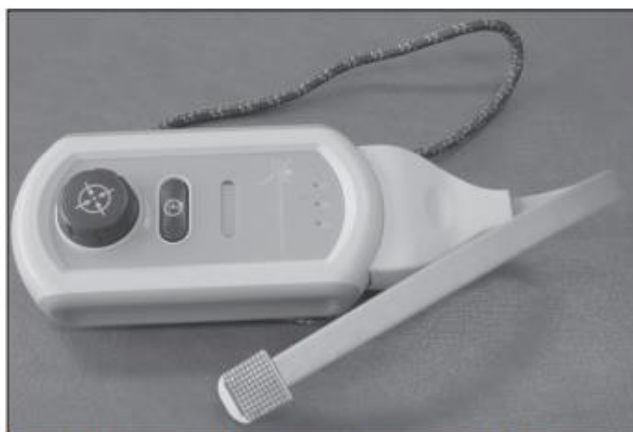
Obr. 1. BrainPort – akcelerometr se stimulačními elektrodami a řídicí jednotka.
