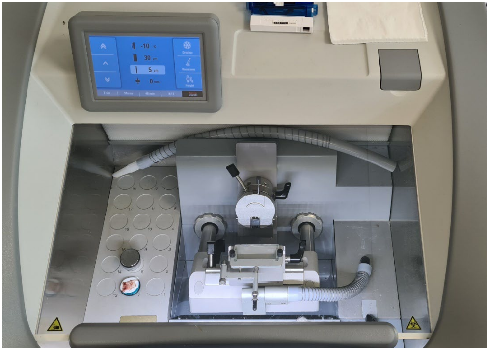
Obrázek 7 – Kryokomora se zabudovaným rotačním mikroskopem a připraveným vzorkem ke krájení (foto autora)
