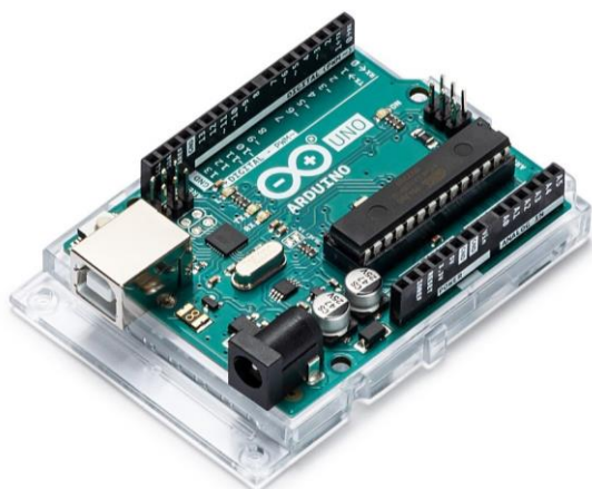
Obrázek 4.1.3.1: Vývojová deska Arduino Uno
