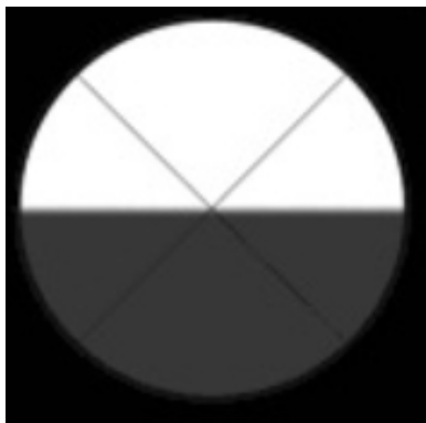
Obrázek 12 „Rozhraní světla a tmy v Abbeho refraktometru“ [40]
