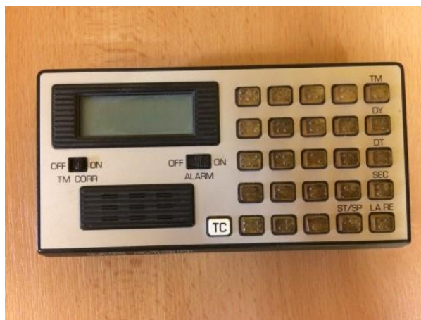
Obrázek 14 – Kalkulačka s Braillovým písmem [29]
