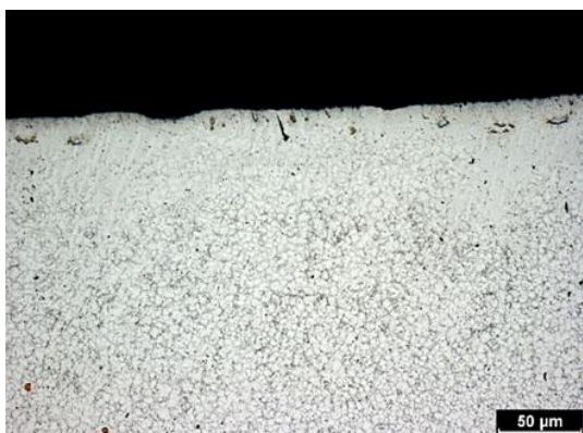
Obr. 14. Laserem zpracovaný povrch vysokochromové karbidické litiny [19].
