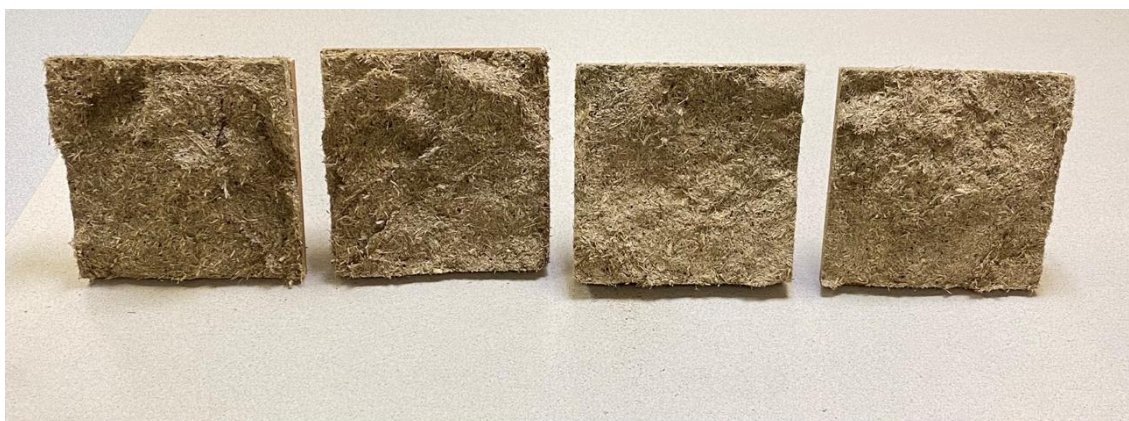
Obr. 38 Vzorčky po zkoušce v tahu - vlastní fotogalerie autora
