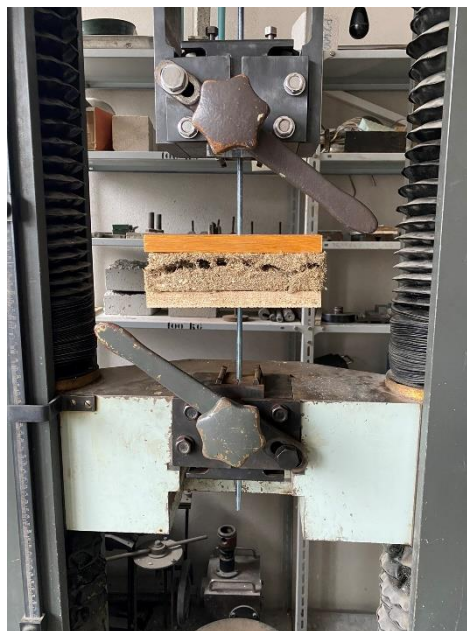
Obr. 15 Stanovení pevnosti v tahu kolmo k rovině desky - fotogalerie autora
