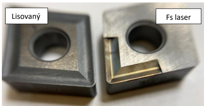
Obr. 85: Fotografie lisovaného a femtosekundovým laserem vytvořeného utvařeče třísek
