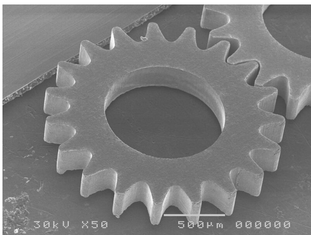
Obr. 2: Mikroobrábění laserem – řezání pro mikroelektronické komponenty (MEMS) [11]
