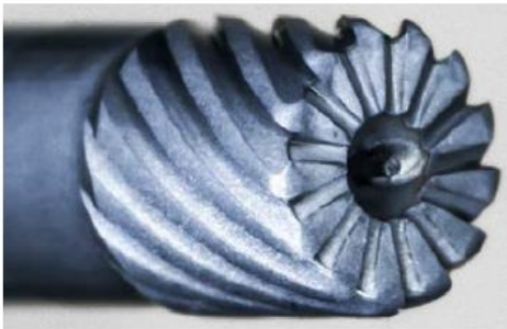
Obr. 20: Laserem vytvořená geometrie na fréze z PCD o průměru 1,8 mm [53]
