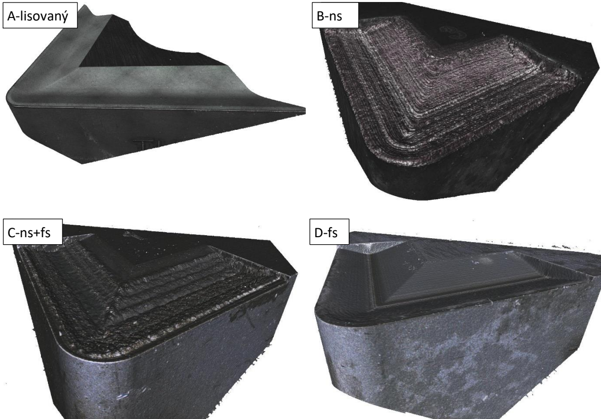
Obr. 95: 3D skeny utvařečů třísek pro referenční (A) a laserem vytvořené vzorky (C-D)
