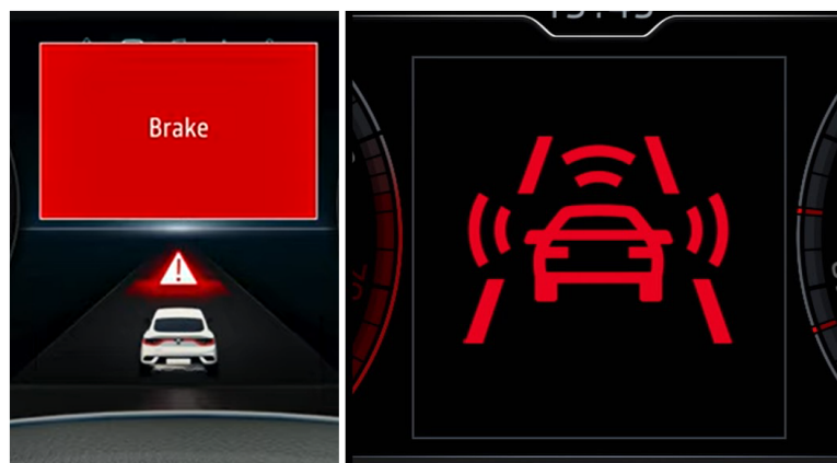
OBRÁZEK 2.7: Ukázka ikon při aktivaci funkce nouzového brzdění; vlevo ve vozidlech Renault [18] a vpravo u vozidel Škoda [23]
