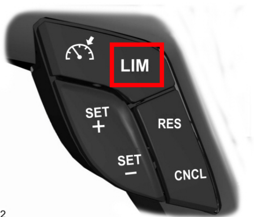
OBRÁZEK 2.16: Ukázka ovládacích tlačítek funkce automatické změny rychlosti dle rozpoznaných značek ve vozidlech Ford [54]
