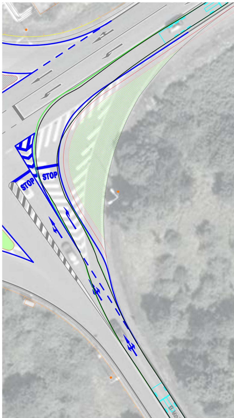
Obrázek 38 - Vlečné křivky NSN na nově navrženém pravém odbočení na jižním rameni
