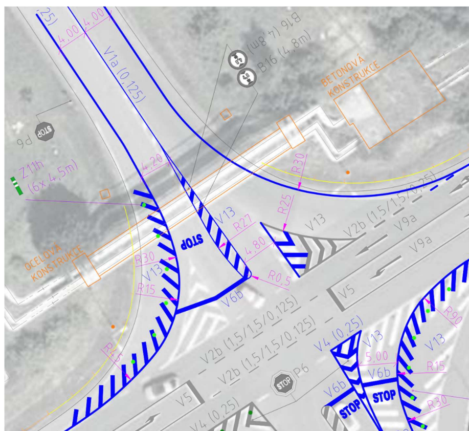
Obrázek 30 - Návrh severního ramene křižovatky
