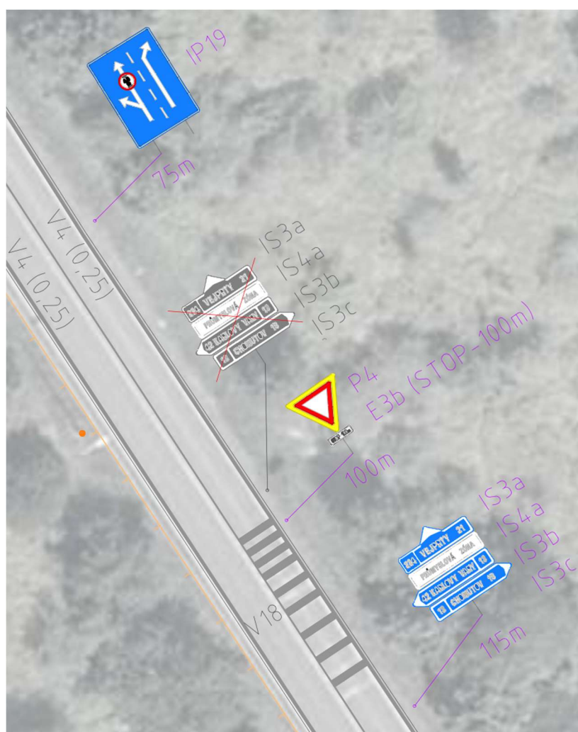
Obrázek 33 - Úprava SDZ na příjezdu od Kadaně (jižní rameno)
