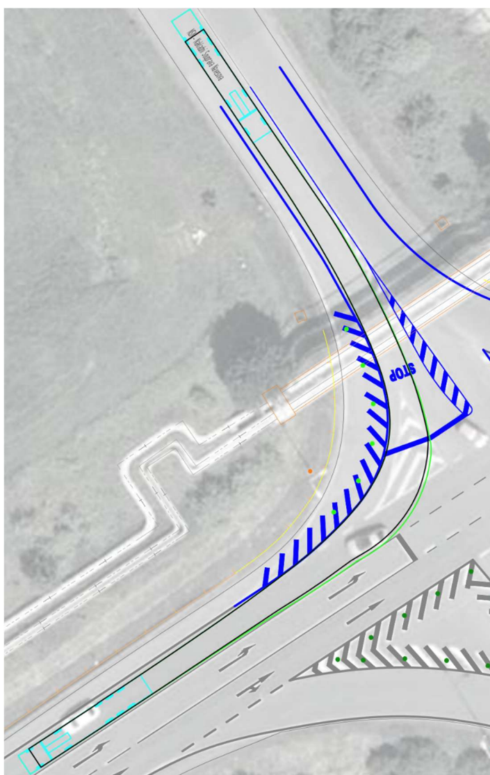
Obrázek 31 - Vlečné křivky NSN na nově navrženém pravém odbočení
