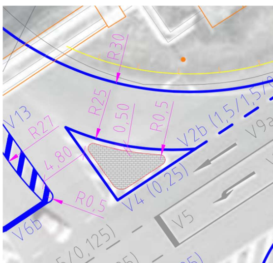
Obrázek 35 - Zvýšený směrovací dopravní ostrůvek na severním rameni
