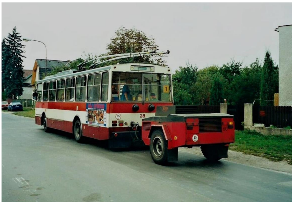
Obrázek 31 – Škoda 14Tr se zapřaženým vozíkem s dieselaagregátem (foto: M. Janků)
