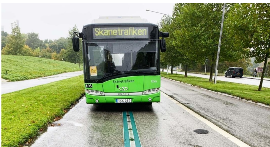
Obrázek 22 – Bezdrátové dobíjení baterií ve Švédsku (zdroj: electrek)
