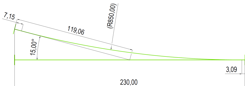
Obrázek 5: Výkres geometrického popisu jednoduché výhybky používané na kolejišti DSFD. Zdroj autor.
