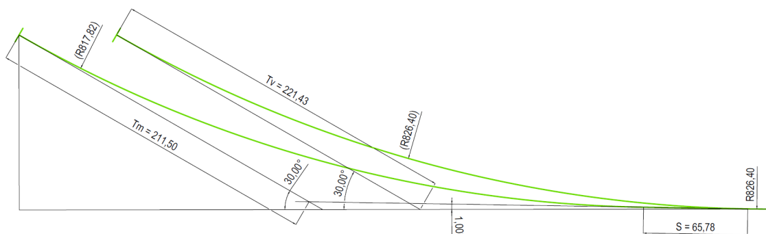
Obrázek 6: Výkres geometrického popisu větší z dvojice prototypů používaných pro popis obloukových výhybek na DSFD. Tm označuje délku malé tečny, Tv označuje délku velké tečny a S označuje délku šikmého posunu (délka přímé koleje v přímé větvi výhybky). Zdroj autor.
