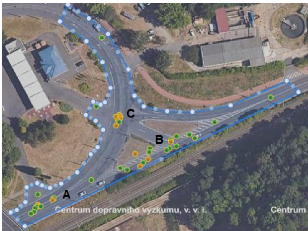
Obrázek 19 – Nehodovost v řešené křižovatce ve sledovaném období (zdroj: nehody.cdv.cz)
