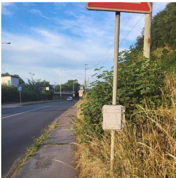
Obrázek 23 – Umístění radaru Vitronic na dopravní značce A11
