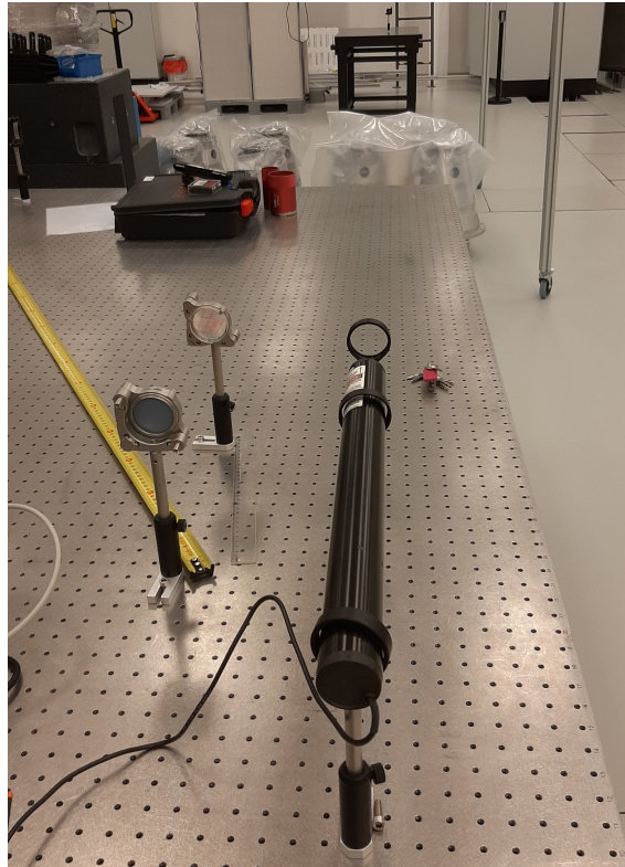
Obr. 5.3. Fotografie aparatury, svinovací metr položen ve směru odrazu.
