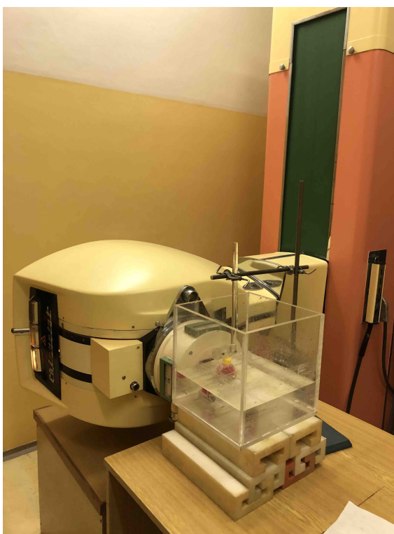
Obrázek 4.7: ^{60}\text{Co} ozařovač a vodní fantom s umístěnou lahvičkou v ozařovací geometrii.
