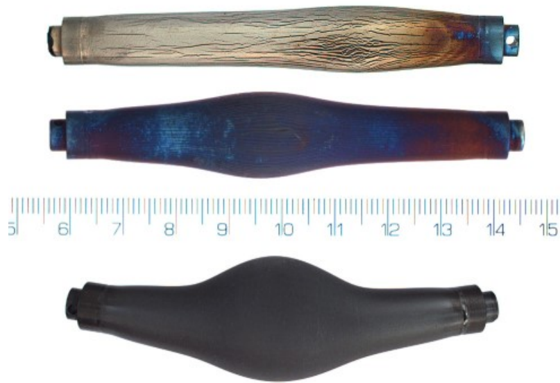
Obr. 3.11: Vzorek s Cr coatingem (nahore), CrN coatingem (uprostřed) a referenční vzorek bez coatingu (dole) po burst testu s tlakem 12 MPa a teplotě 600 °C [135]
