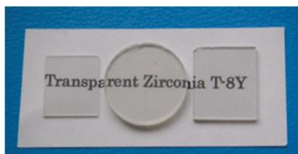
Obr. 17 IR průhledný YSZ vyrobený metodou lisování za horka, převzato z [73]
