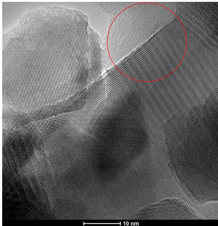
Obr. 32 TEM snímek ZnO@Y_2O_3 , červeně je označeno rozhraní ZnO a Y_2O_3
