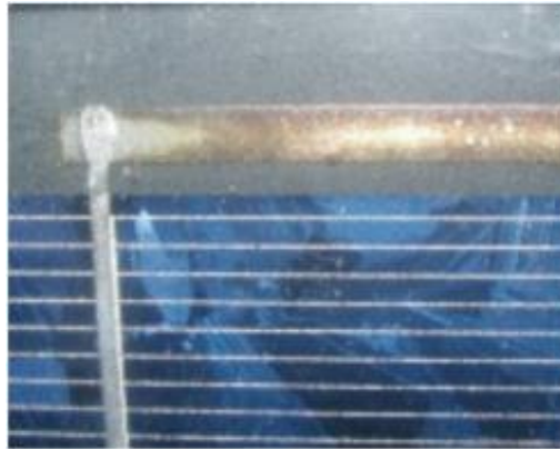
Obrázek 12: Koroze kovového plišku, [4]
