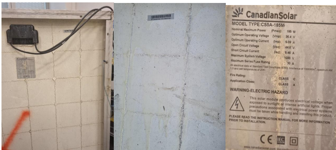
Obrázek 29: Neopravený modul (vlevo), opravený pomocí gelu (uprostřed štítek modulu (vpravo)
