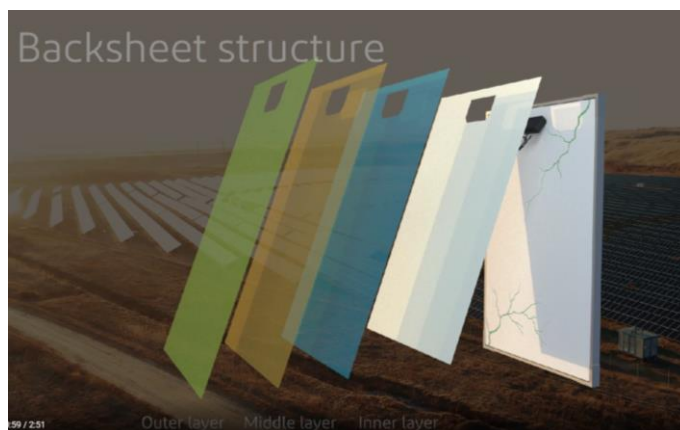
Obrázek 22: Struktura folie Tedlar PV Rescue Tape, [14]
