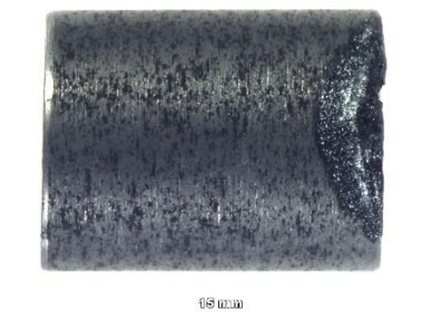
Obrázek 33: Vzorek FCL_2012 z ramp testu vysokoteplotní oxidace
