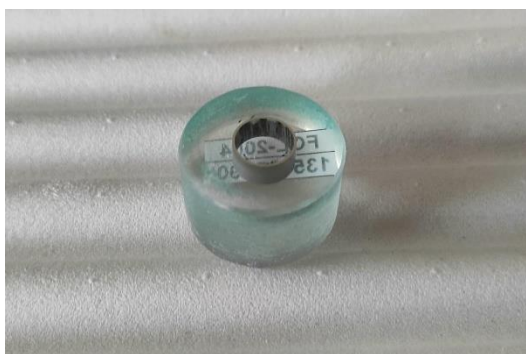
Obrázek 28: Vzorek zalitý pryskyřicí připravený pod mikroskop
