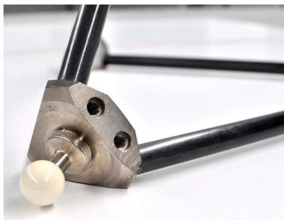
Obr. 19: Detail vrcholu artefaktu typu Ball Tetrahedron [19]
