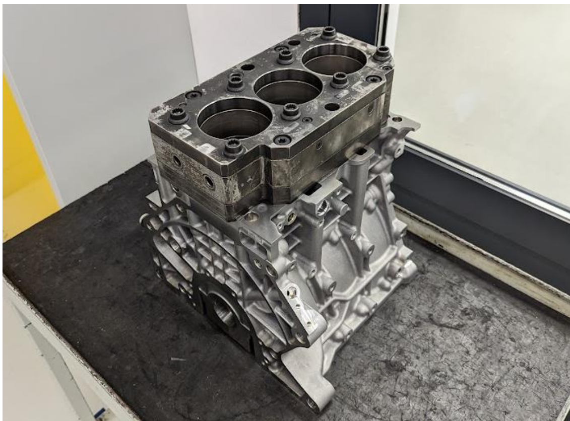
Obr. 45: Měřený díl - blok motoru 1.0 TSI EVO
