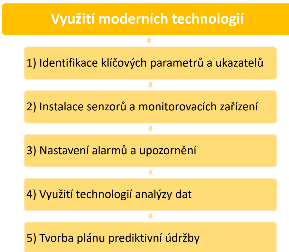
Obr. 31: Kroky pro využívání technické diagnostiky a následný přechod k prediktivnímu systému údržby
