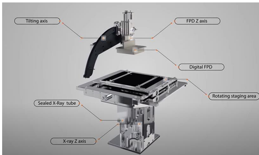
Obrázek 22: Schéma konstrukce typově podobného výpočetního tomografu, který se bude využívat ve firmě Škoda auto [61]
