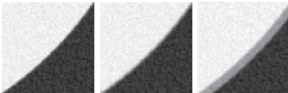
Obrázek 36: Vlevo – bez posunutí osy, uprostřed – jemné posunutí o cca 0,5 pixelu, vpravo – posunutí o více jak 2 pixely [32]
