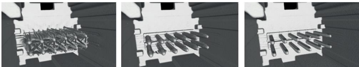
Obrázek 34: Vlevo – bez korekce, uprostřed – silnější filtr, vpravo – silnější filtr + AMMAR [32]
