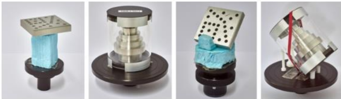
Obrázek 62: Pozice při měření etalonů Step cylinder a Hole plate [48]
